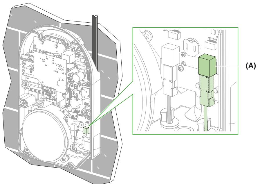
**fr** Un deuxième connecteur permet de procéder à du chaînage ethernet.
