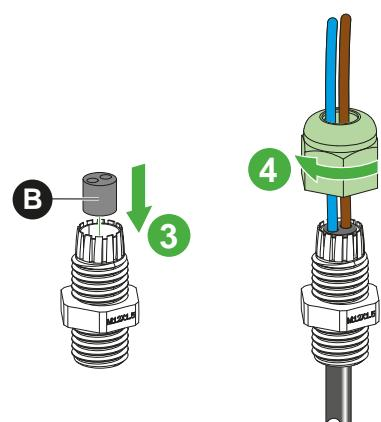
**fr** Si le diamètre du câble est supérieur à 6 mm, utiliser le passe-câble (B) à double entrée dans le presse-étoupe M12
