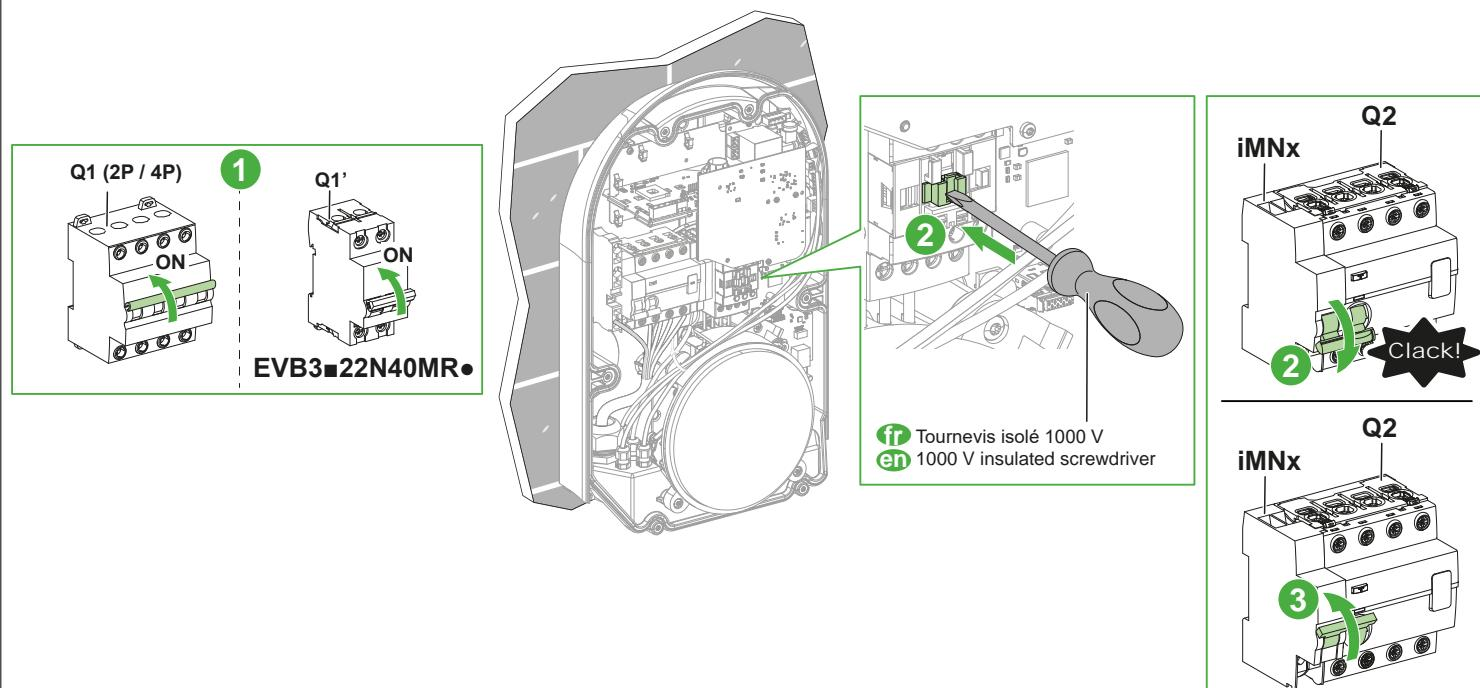
**fr** Contrôlez le déclencheur à minimum de tension iMNx :
