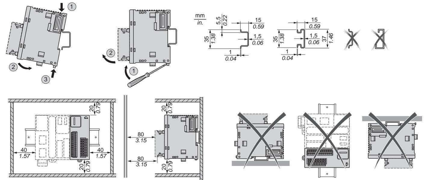
**Mounting on panel with attachment kit TMAM2 / Montage sur panneau avec kit de fixation TMAM2 / Befestigung auf der Montageplatte mit dem Montagesatz TMAM2 / Montaje en panel con kit de fijación TMAM2 / Montaggio su pannello con kit di fissaggio TMAM2 / 使用安装套件 TMAM2 安装到面板上。**
