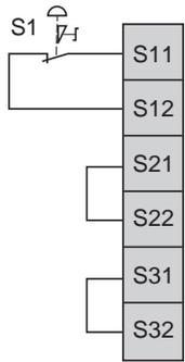
Wiring 2 channels / Câblage 2 canaux / Verdrahtung 2 Kanäle / Cableado de 2 canales
