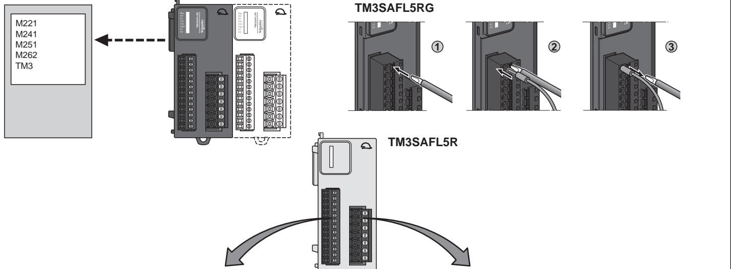
Screw terminal blocks 3.81 mm (0.15 in.) pitch / Borniers à vis pas de 3.81 mm
